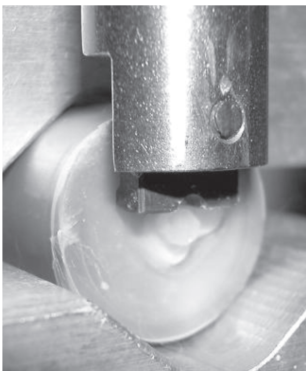
FIGURA 1 - Dispositivo utilizado para realização dos testes de resistência de união ao cisalhamento
