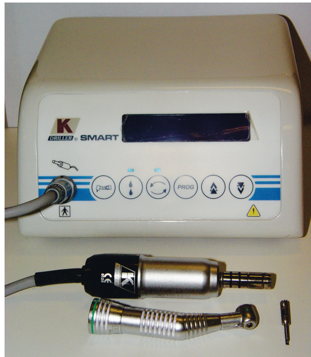
Figura 1 - Motor, micromotor, contra-ângulo redutor 16:1 e broca trefina para osso de aço inoxidável de 3.0 mm de diâmetro utilizados para construção do tissue microarray artesanal
