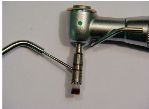
Figura 4 - Remoção do cilindro de parafina da broca trefina com auxílio de sonda exploradora
