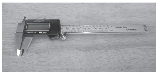
**Figura 1** - Paquímetro digital
