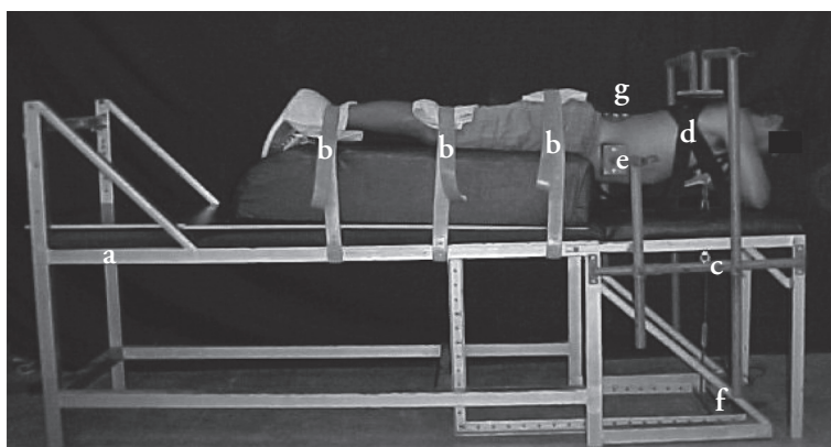
Figura 1 - Postura dos sujeitos e equipamentos utilizados para a CVM e contrações submáximas. a: mesa de testes; b: cintos de couro; c: célula de carga; d: colete; e: limitadores de movimento; f: indicador digital; g: eletrodos
