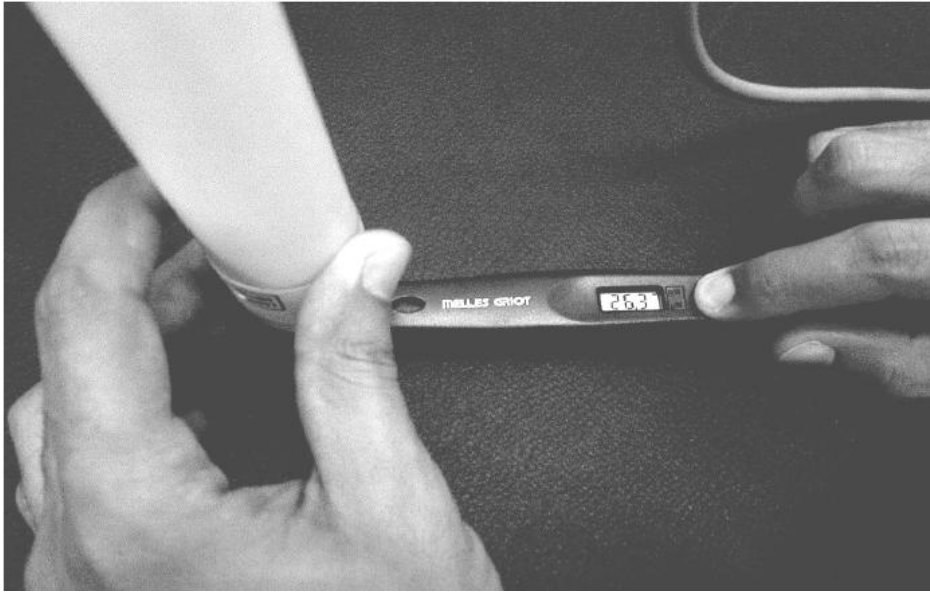
FIGURA 1 - Representação da realização do teste de potência, com a utilização do instrumento medidor de potência e da caneta emissora laser
