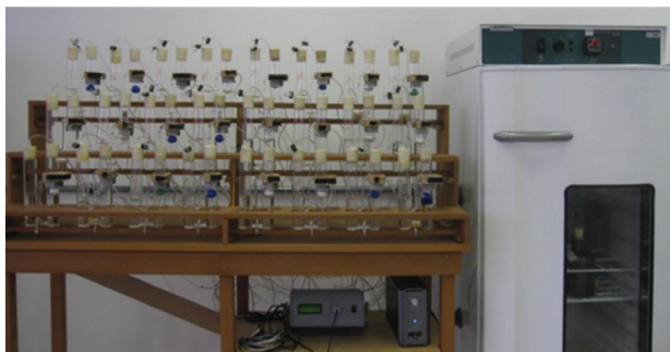
Figura 1 - Sistema automatizado de medição de biogás acoplado a incubadora bacteriológica
